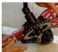
キックバイクから自転車に「へんしん」させる際は自転車本体を上下逆さに裏返し、ペダル部を取り付ける。「へんしんバイク2」と「C14」に搭載された第2世代の独自のペダル取付機構は2024年に特許申請中だ。
